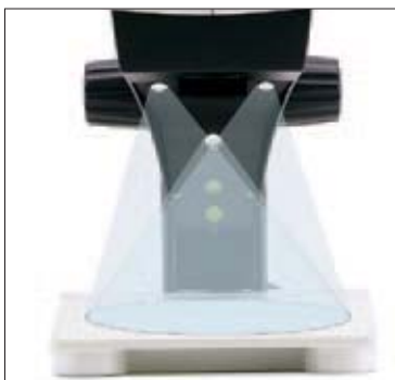
Épiscopie de niveau 1 : les 5 LED sont allumées et fournissent une intensité lumineuse maximale.
