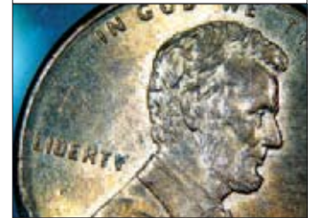
Épiscopie de niveau 3 : les 2 LED inférieures éclairent à plat les objets aux structures fines et augmentent ainsi le contraste.
