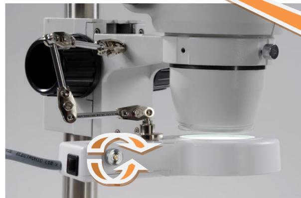
1. Interrupteur ON/OFF situé sur le boîtier
