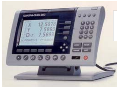
Calculateur geometrique Quadra Chek QC220 / ND1200 de Heidenhain
