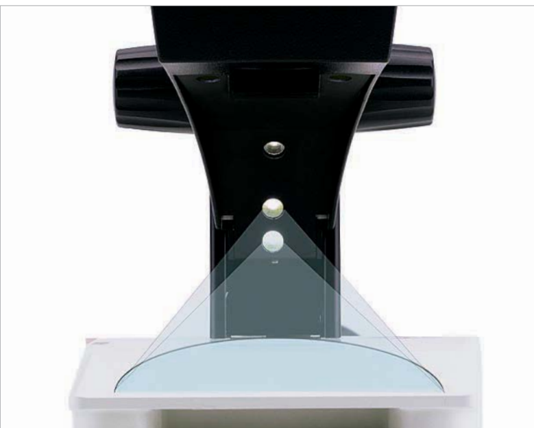
Épiscopie de niveau 1 : les 5 LED sont allumées et fournissent une intensité lumineuse maximale.
