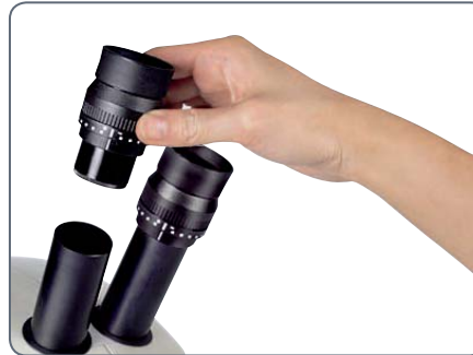
Verstellbare Brillenträgerokulare mit geraden Augenmuscheln
