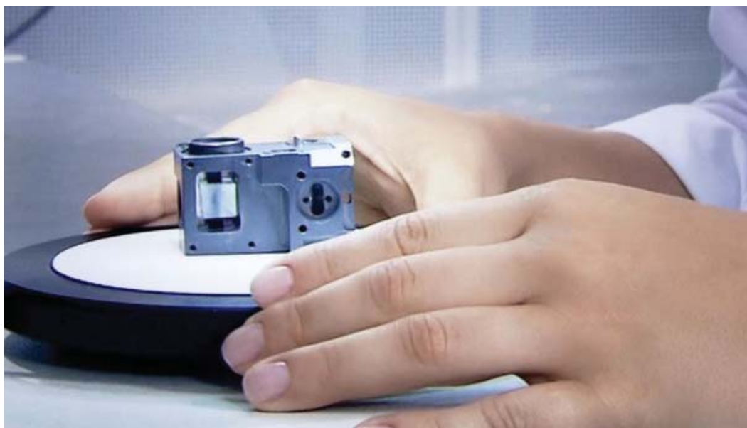
5 La platine à glissements aide au positionnement de l'échantillon, en particulier pour les forts grossissements.
