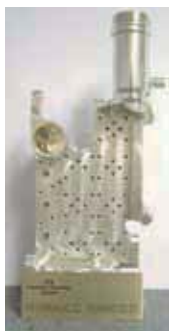
F1 car hydraulic manifold
