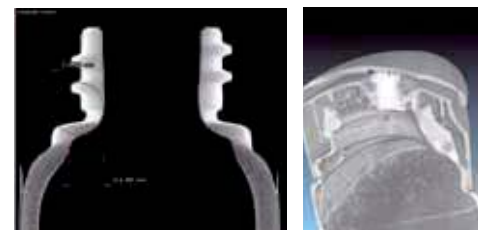
Wandstärken Kontrolle von Flaschen und Behältern
