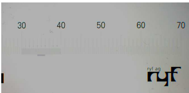
Teilung: 1.0mm 0.5mm, 0.1mm und 0.01mm Divisions de 1.0mm, 0.5mm, 0.1mm et 0.01mm
