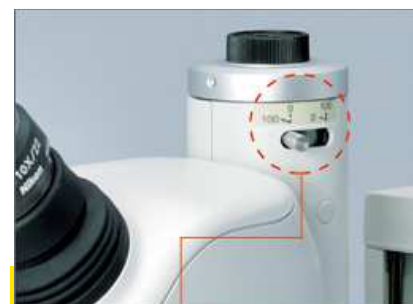
Umschalthebel von Binokulartubus auf TV Tubus
