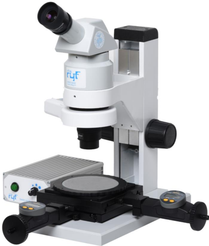
links: RSMZ-ST2 Stativ mit dem kompakten Messmikroskop Ryf RMM28, mit X-Y Tisch 50x50mm, Digitalmessspindeln von Sylvac (oder Mitutoyo), LED Durchlicht und NKL18 Beleuchtung Ci-contre: statif RSMZ-ST2 avec microscope de mesure Ryf RMM28, avec table x-y 50x50mm, tambour numérique Sylvac (ou Mitutoyo), éclairage LED diascopique et éclairage NKL18
