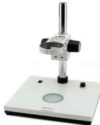
ST-151 Base plate et large avec support de tête et système de mise au point. Eclairage intégré à LED avec variateur d'intensité. Type colonne. Base: 320x280mm ; colonne: Ø32x360mm.
