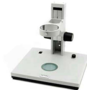
ST-153 Base plate et large avec support de tête et système de mise au point. Eclairage intégré LED, avec variateur d'intensité. Crémaillère fixe coulissante. Base: 320x280mm; crémaillère : 360mm.
