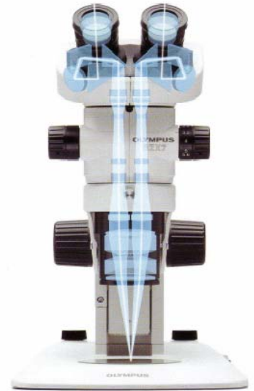
Das optische System nach Galileo besitzt zwei (rechts/links) getrennte, unabhängige und parallele Zoomstrahlengänge, die durch ein einziges Objektiv fokussiert werden. Dieses System ermöglicht Abbildungen höchster Qualität bei maximaler Modularität.
