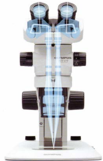
Des optiques galiléennes comprennent deux (droite/gauche) trajets optiques indépendants et parallèles qui convergent vers le point focal avec un objectif. Le système garanti des performances optiques supérieures et une modularité fonctionnelle.
