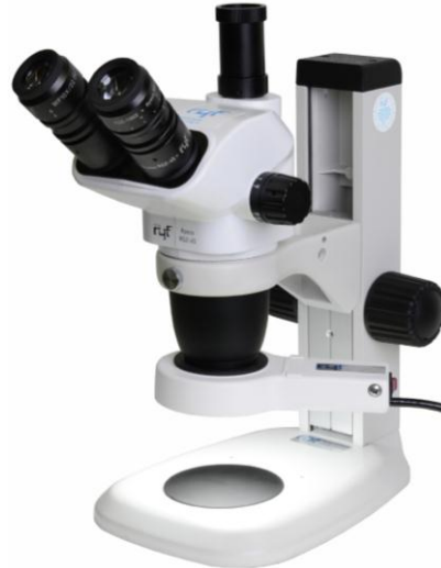
Les sets RSZ-45 (T) contiennent: corps zoom RSZ-45 (T), 1 paire d'oculaires 10x avec bague pour porteurs de lunettes, statif comme sur la photo, éclairage annulaire Ryf LED ou fluorescent NKL18 à choix et adaptateur
