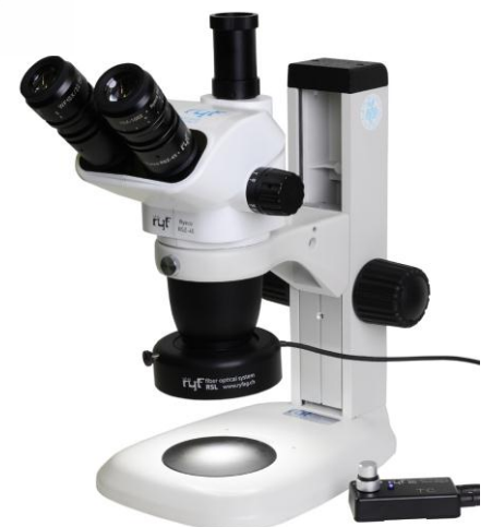
Les sets RSZ-45 (T) contiennent: corps zoom RSZ-45 (T), 1 paire d'oculaires 10x avec bague pour porteurs de lunettes, statif comme sur la photo, éclairage annulaire Ryf LED ou fluorescent NKL18 à choix et adaptateur
