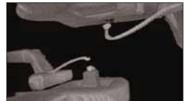
Beschädigte Drahtverbindung in IC
