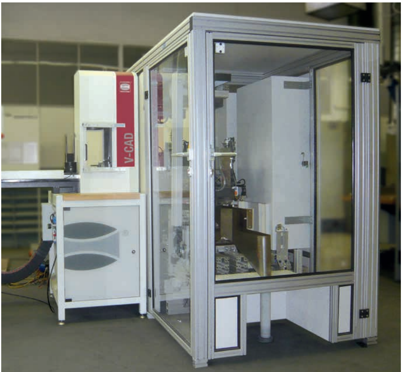
Messzelle mit zwei V-CAD Modulen und anschließender Verpackungseinheit
