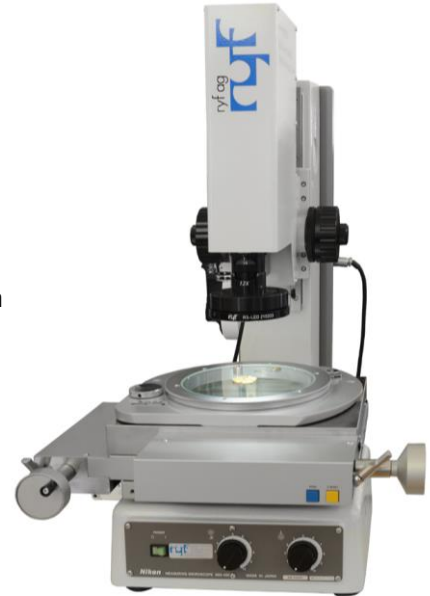
MM400 avec table X-Y de 100x100mm et table tournante à 360°
