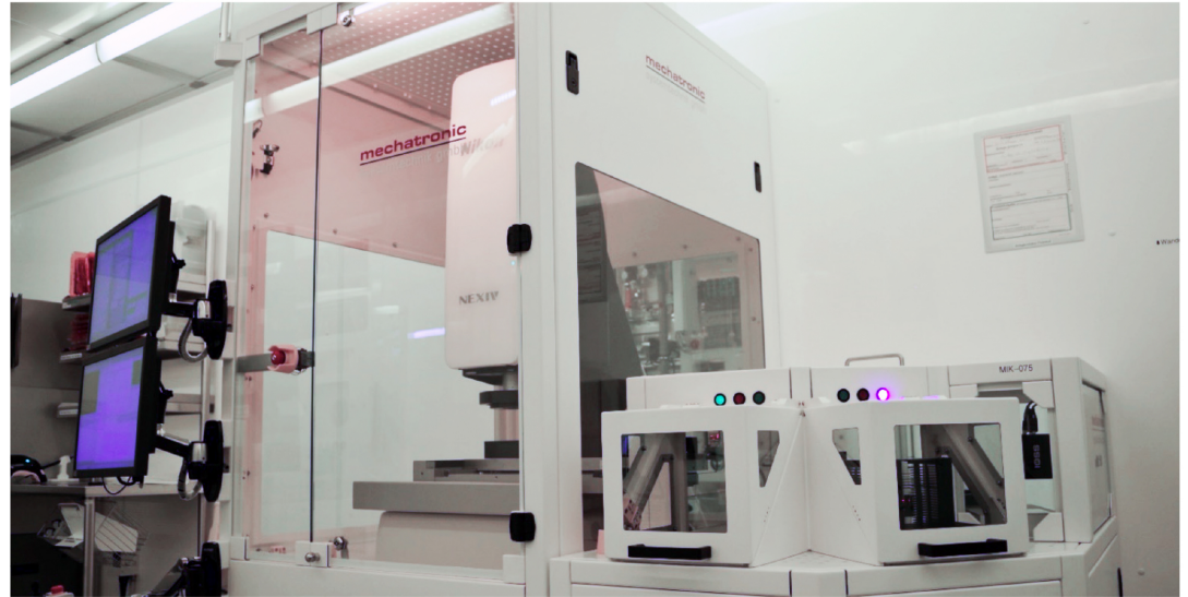
Nikon Metrology NEXIV VMZ-R3020, automatisiert mit einem mWL150 Single-Arm Wafer Handling Tool. Dies ist das erste System, das im Nürnberger Werk der Semikron Elektronik GmbH installiert wurde.
