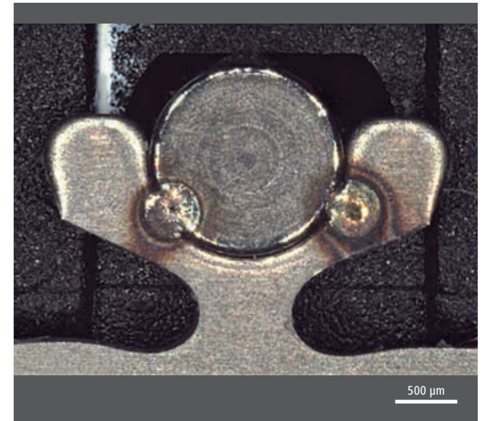
Laserschweißnähte, Objektiv: 1,6x, erweiterte Tiefenschärfe, LED-Ringlichtbeleuchtung
