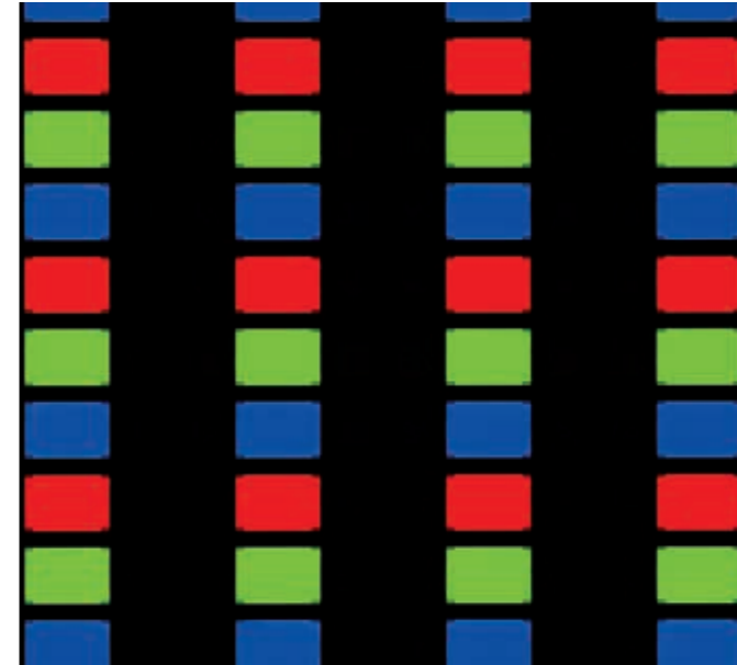
TFT-Display, Hellfeld, Durchlicht; rote, grüne und blaue Sub-Pixel
