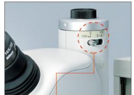
Umschalthebel von Binokulartubus auf TV Tubus
