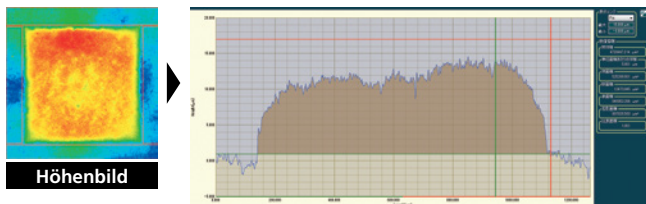
Volumen- und Bereichsdarstellung von vorgegebenen Riefentiefen und Profilspitzen
