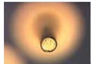
La sonde circulaire apparaît sur la position anormale de l'épingle sans échec de la mesure
