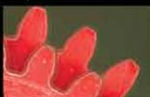
Image EDF à engrenage à double denture avec un calque CAD 2D.
