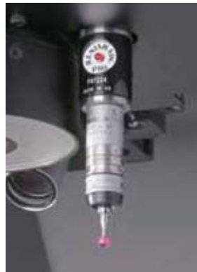
Tête de palpeur Renishaw® avec système de palpement à déclenchement par contact TP20
