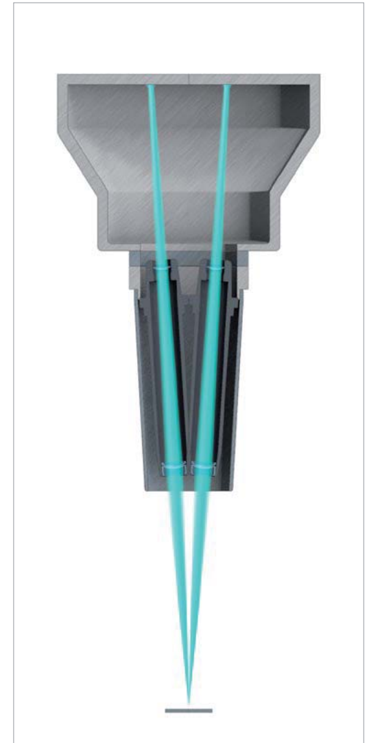
Prinzip Strahlengang eines Greenough-Stereomikroskops
