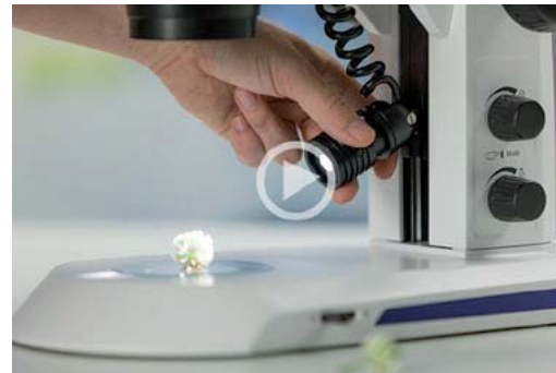
Ändern Sie die Position des Spots und zoomen Sie, um starke Schatteneffekte für einen kontrastreichen 3D-Eindruck zu erzeugen. Das in der niedrigsten Position erzielbare Streiflicht hebt feine Strukturen auf flachen Objekten hervor.
