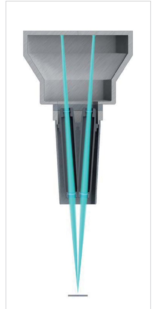
Strahlengang eines Greenough-Stereomikroskops
