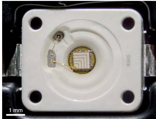
Besonders heller LED-Chip, Bonddrahnte und Verpackung, LED-Spot K, schrages Auflicht, Zoom 1,25-fach
