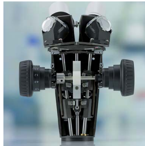
Stemi 508 ist ein nach dem Greenough-Prinzip funktionierendes Stereomikroskop mit zwei im Winkel von 11^\circ geneigten Strahlengängen und mit einem leistungsstarken 8:1-Zoom.
