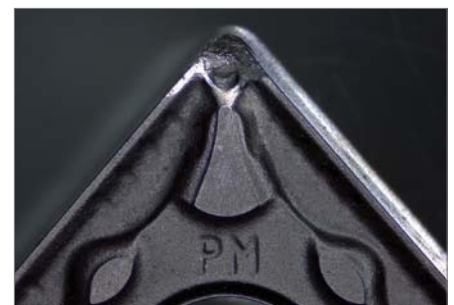
Wendeschneidplatte mit Zeichen von Werkzeugverschleiß. Auflicht, Ringlicht, Zoom 1,0x
